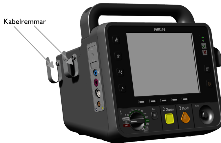
Bild 24 Kabelremmar: vänster och framifrån
