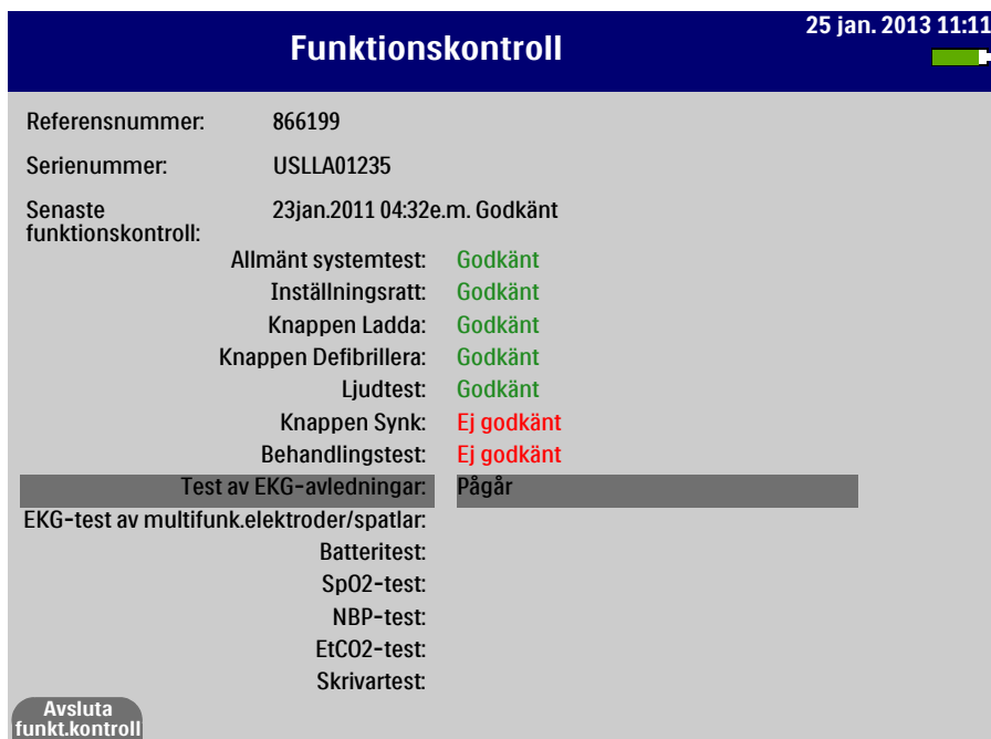
Bild 74 Skärm vid pågående funktionskontroll
